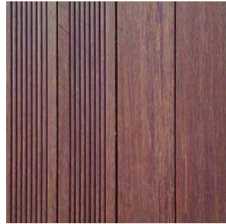
Lames de Bamboo X-treme dans différents contextes d'entretien et de nettoyage: vieilli, avant nettoyage (à gauche), vieilli après nettoyage (au centre) et après application du saturateur base aqueuse (à droite).
